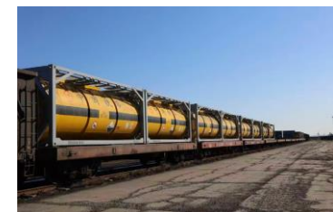
硫酸罐箱铁路运输
