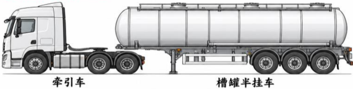
槽罐半挂车组合
