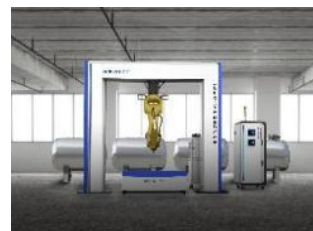
畜牧设备水、料槽焊接
